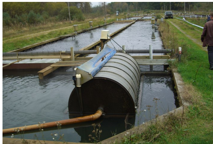
Mynd 5.24. Tromlusía ofan í lengdarstraumskari í danskri landeðisstöð (Ljósmynd: Jóhann Geirsson).
