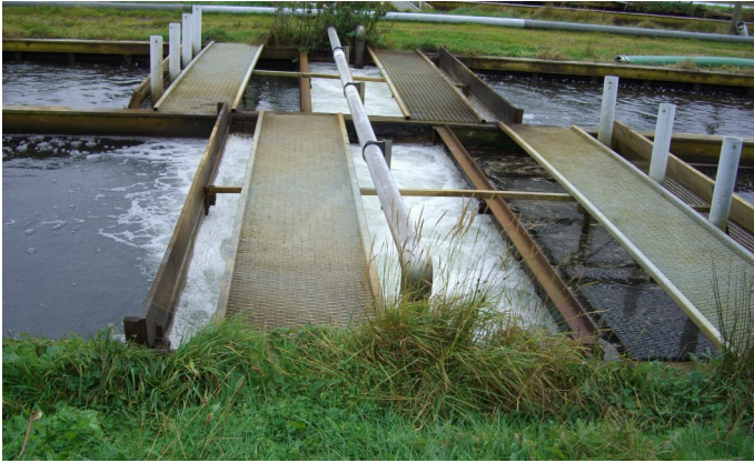
Mynd 5.15. Setþró og loftun í lengdarstraumskari í danskri landeldisstöð. Rörin ganga niður í trektina og er lyft upp þegar tæma á gruggagnir úr henni (Ljósmynd: Jóhann Geirsson).
