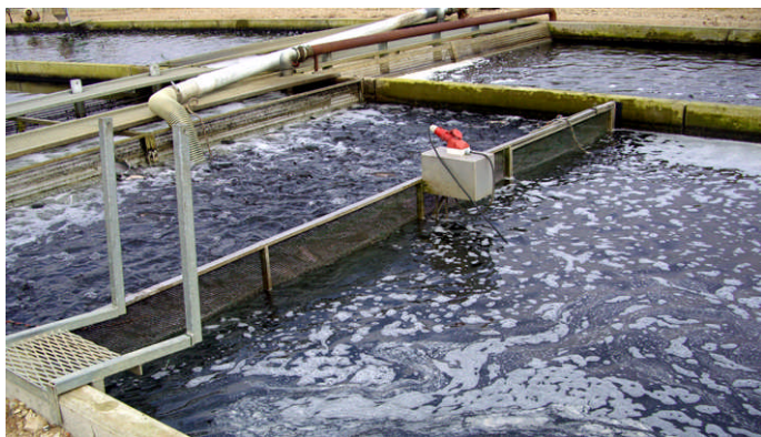
Mynd 35. Rafdrifin rekstrargrind heldur fiski að barka frá fiski-dælu (Ljósmynd: Jóhann Geirsson).
