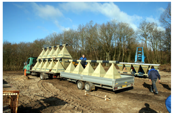
Mynd 6. Gildrur fyrir skít og fóðurleifar (Ljósmynd: Sören Jøker Trachsel).
