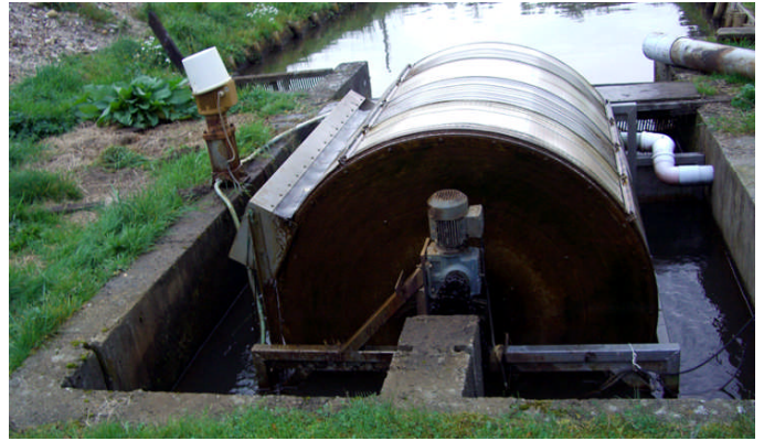
Mynd 27. Tromlusía við frárennsli frá hefðbundinni stöð (Ljósmynd: Jóhann Geirsson).
