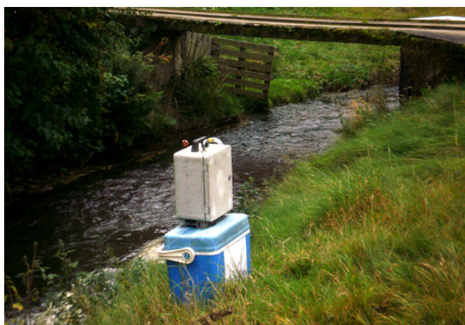
Mynd 2. Færanleg mælistöð til að mæla frárennslisvatn (Ljósmynd: Jóhann Geirsson).
