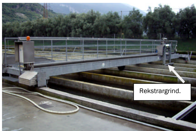
Mynd 56. Rekstrarútbúnaður af stærri gerðinni til að þrengja að fiski (Ljósmynd: Jóhann Geirsson).
