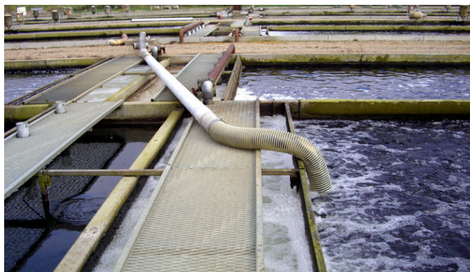
Mynd 37. Fiski dælt úr langkeri í flokkunarvél (Ljósmynd: Jóhann Geirsson).
