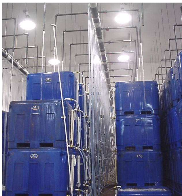
Mynd 2.3. Geymslukör frá Sæplasti fyrir lifandi krækling. Á myndinni til vinstri sést hvítt utanálíggjandi rör sem stjórnar vatnshæðinni í karinu. Til hægri má sjá rör ofan í karinu sem leiðir loft undir fálscan botn.
