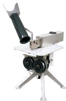
Mynd 4.3. Einfaldur pökkunarbúnaður fyrir lifandi krækling. Á myndinni til hægri er kræklingur í umbúðum úr pökkunarvélinni (67).
