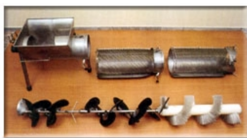
Mynd 3.2. Afklasari frá Tellers Aqua á Spáni sem losar kræklinginn í sundur, þvær og flokkar minnsta kræklinginn frá. Á myndinni til hægri er afklasari með framlengingu til að losa í sundur krækling með sterkari spunaþræði (78).
