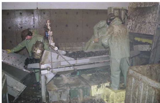
Mynd 2.5. Kræklingahengjur fara í gegnum burstavél sem losar kræklinga af böndum.
