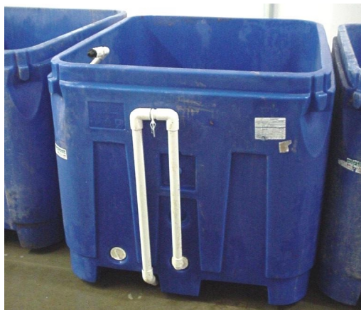
Mynd 2.3. Geymslukör frá Sæplasti fyrir lifandi krækling. Á myndinni til vinstri sést hvítt utanálíggjandi rör sem stjórnar vatnshæðinni í karinu. Til hægri má sjá rör ofan í karinu sem leiðir loft undir fálscan botn.
