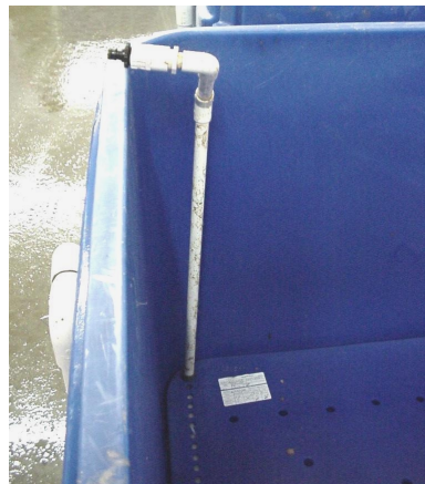
Mynd 2.3. Geymslukör frá Sæplasti fyrir lifandi krækling. Á myndinni til vinstri sést hvítt utanálíggjandi rör sem stjórnar vatnshæðinni í karinu. Til hægri má sjá rör ofan í karinu sem leiðir loft undir fálscan botn.
