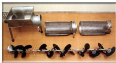
Mynd 6.10. Snigill í afklasaranum þrýstir kræklingnum fram og losar hann í sundur. Á myndinni er afklasari með lengingu sérstaklega hannaður til að afklasa krækling með sterka spunaþræði ( www.aguin.com/ingles.htm ).
