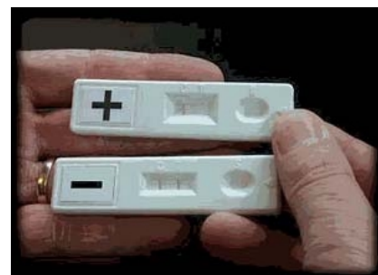
Mynd 5.3. MIST Alert™ próf til að mæla PSP og ASP þörungaeitur í skelfiski (www.jellett.ca).
