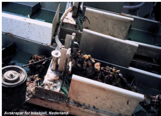
Avskrapar for bláskjell, Nederland. Kræklingur losaður af bandi með því að draga hann í gegnum þrengingu.
