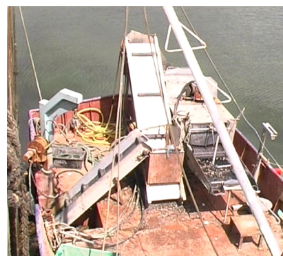
Uppskerubúnaður á Írlandi. Færiband flytur kræklingahengju upp að vinnslubúnaði.
