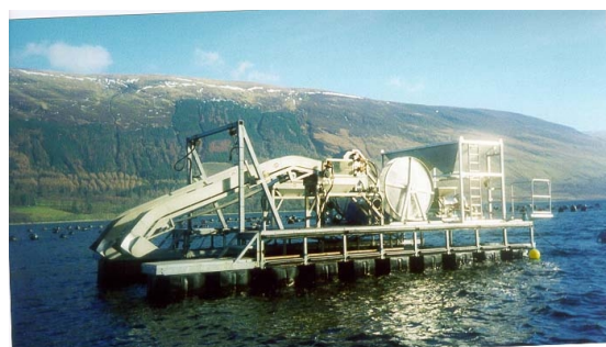
Sérhæfður prammi notaður við uppskeru á kræklingalínunum með tvöfalda burðarlínu ( http://www.xplora.no/Xplora%20Hostekatamaran.htm )
