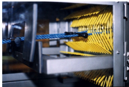
Burstavél losar krækling af ræktunarbändi ( http://www.xplora.no/Xplora%20Hostekatanaman.htm ).
