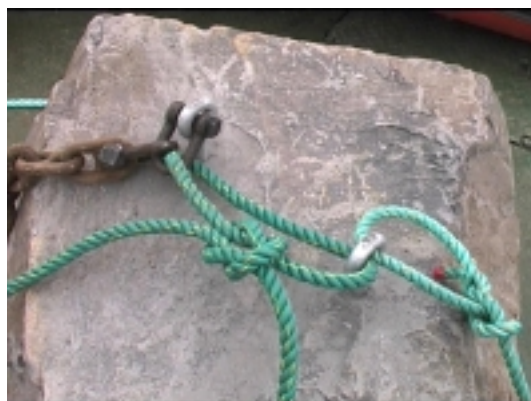
Mynd 2.2. Tveir augnboltar hafa verið reknir niður í grjótið. Annar er til að festa keðju og hinn til að festa tóg með belg sem tekið er í þegar færa á steininn. Band sem er fest í báða augnbolta er notað til að hýfa grjótið frá borði.
