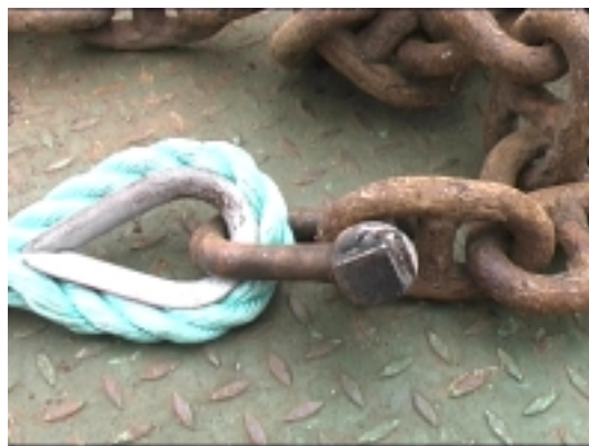
Mynd 2.4. Frágangur á festingu úr keðju í kaðal. Bolti í lás er lóðaður fastur.
