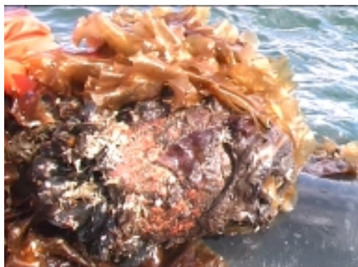
Mynd 2.5. Gamalt rauðbrúnt nótarflot á kræklingalínu við Bjartheyjarsand. Flotið er búið að vera rúm tvö ár í sjó og sést í það þar sem búið er að hreinsa af ásætur.
