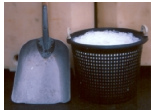
Ísskófla og karfa sem hægt er að nota til að skammta rækju eða ís í kar.
