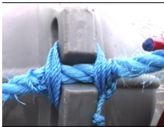
Mynd 2.13. Festing flota á Exploralínu. Burðarlínan byrjuð að slitna.
