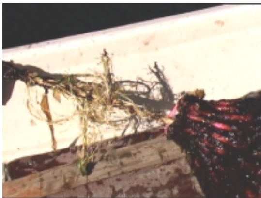
Mynd 2.12. Flottóg á línubelg byrjað að slitna. Hér vantar slöngu utan um flottóg.
