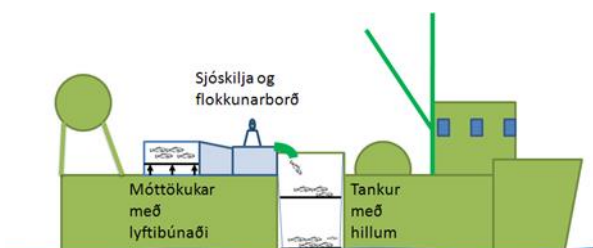
Mynd 4.15. Móttökukar með lyftanlegri rist til að auðvelda vinnu og flokkun á fiski niður í flutningstank (Teikning: Valdimar Ingi Gunnarsson).
