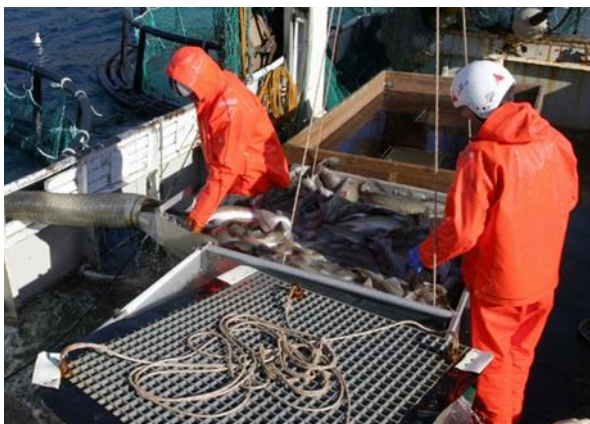
Mynd 4.24. Tvöfaldur tankur um borð í Halldóri Sigurðssyni ÍS 14. Fremst er hillan sem tekin hefur verið upp og fjær er verið að lyfta falska botninum til að losa fisk úr tankinum (Ljósmynd: Valdimar Ingi Gunnarsson).
