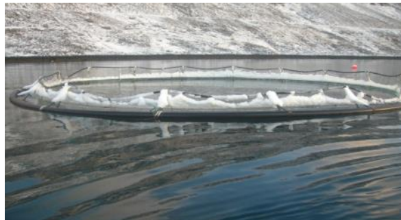
Mynd 2.9. Eldiskví með brotnar baulur við Þúfneyri í Patreksfirði þann 6. janúar 2011 (Ljósmynd: Ólafur Haraldsson).
