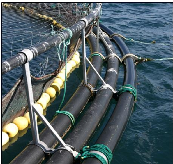
Mynd 6.5. Eldiskví með þremur flotörum (Ljósmynd: Valdimar Ingi Gunnarsson).
