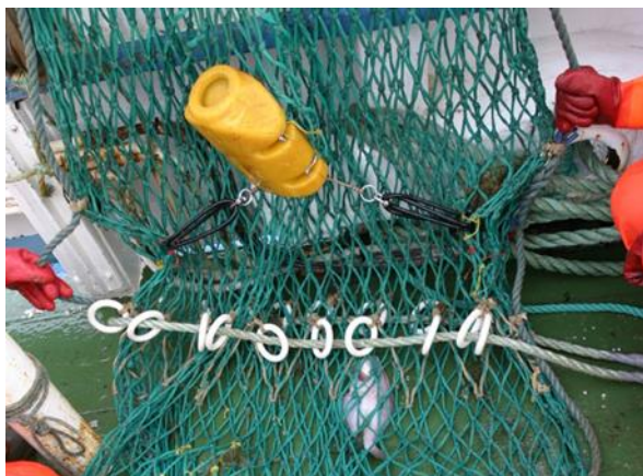
Mynd 5.15. Aflnemi sem gefur upplýsingar um afla er hafður framan við gjörð og strektur á teygjunni til að auka næmni hans (Ljósmynd: Valdimar Ingi Gunnarsson).
