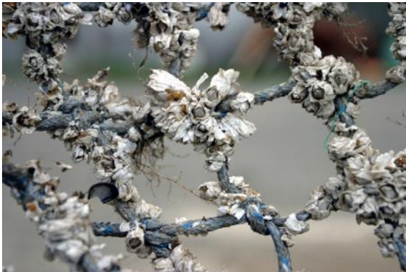
Mynd 2.17. Hrúðurkarlar á netpoka sem settur var í sjó í apríl. Netpokinn er úr trollgarni og var ekki meðhöndlaður með gróðurhamlandi efnum (Ljósmynd: Valdimar Ingi Gunnarsson).
