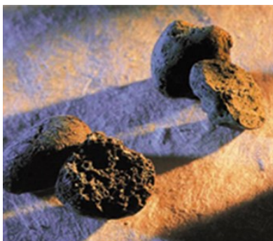
Mynd 10.4. Þaninn leir ( www.filtralite.com ).
