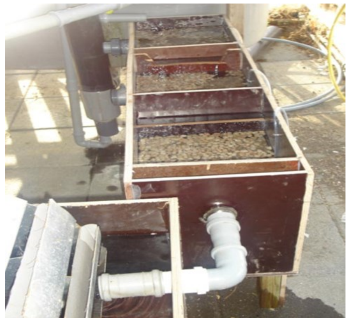
Mynd 10.8. Þriggja hólfa kassi sem vikursía í tilraunarverkefni (Ljósmynd: Sveinbjörn Oddsson).
