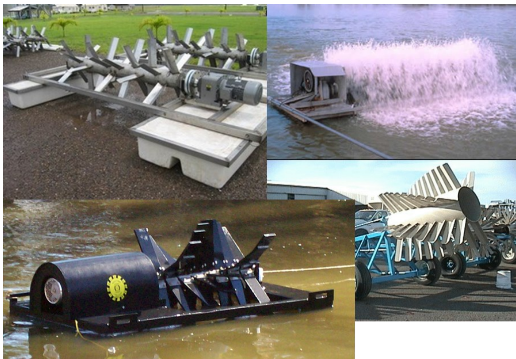
Mynd 6.19. Nokkrar gerðir af spjaldhjólaloftara (myndir frá söluaðilum, teknar af netinu).
