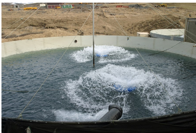
Mynd 6.16. Úðari með 360°geisla hjá Fiskeldinu Haukamýri (Ljósmynd: Valdimar Ingi Gunnarsson).
