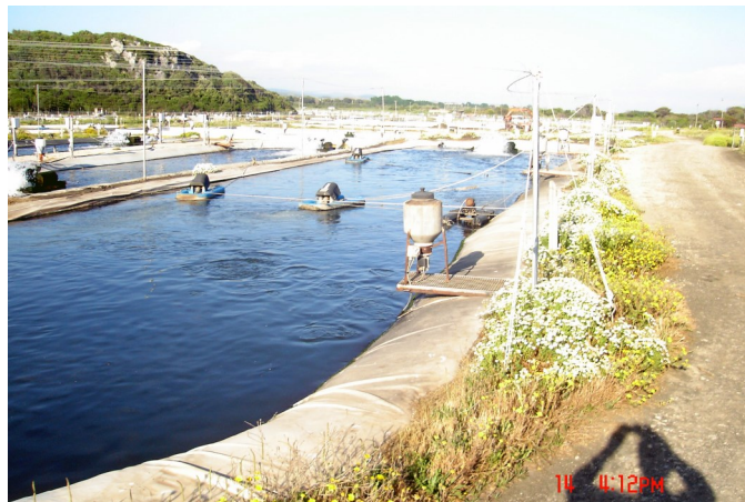
Mynd 6.21. Loftskrúfudælur í lengdastraumskari á Ítalíu (Ljósmynd: Valdimar Ingi Gunnarsson).
