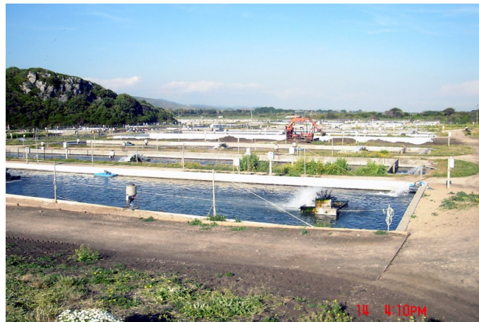
Mynd 6.18. Spjaldhjólaloftari í lengdarstraumskari í stórrí landeldisstöð á Ítalíu (Ljósmynd: Valdimar Ingi Gunnarsson).
